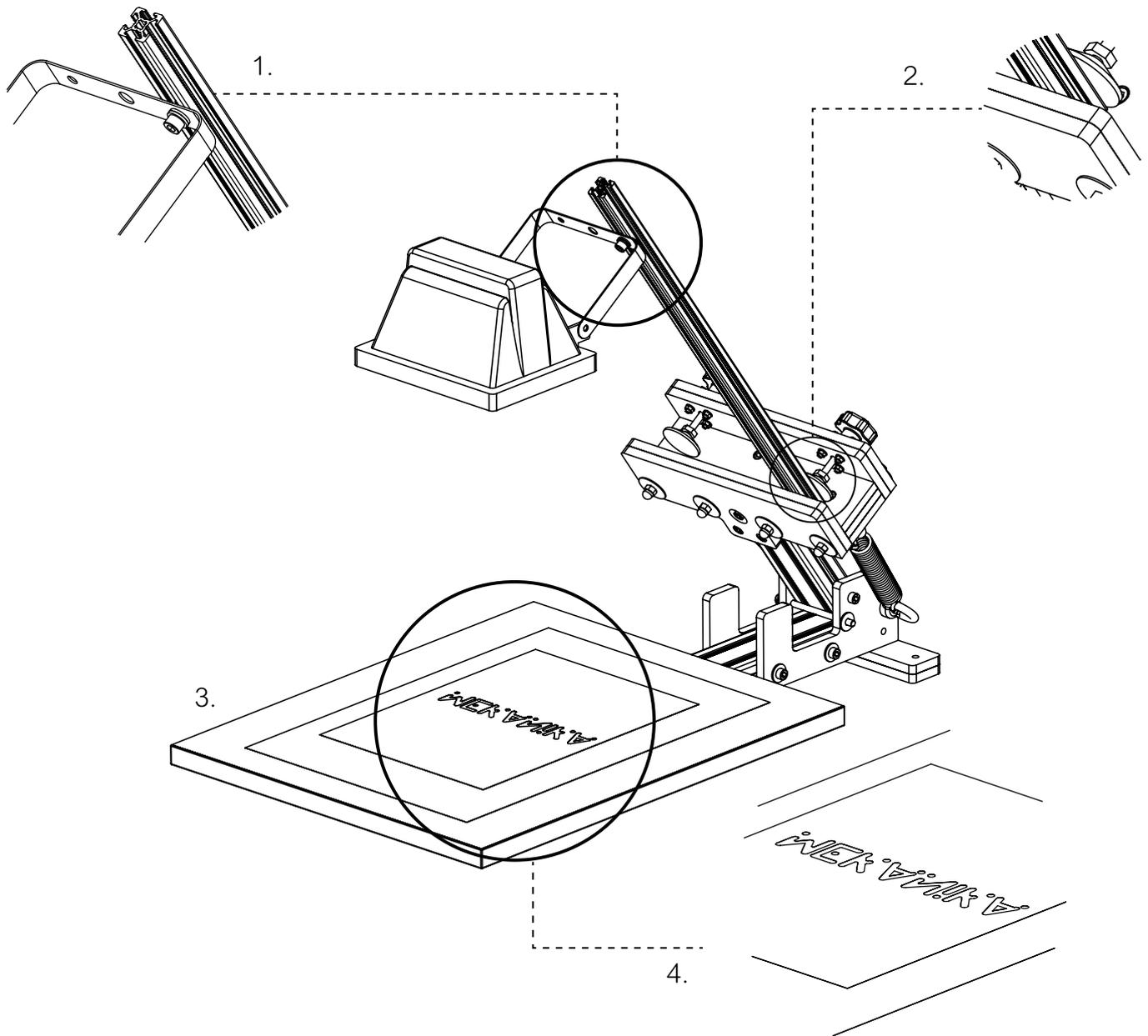
**1.** Fixez le spot halogène sur le profilé aluminium 20x20x500mm à l'aide de la vis M6x10, des rondelles et de l'écrou carré fourni. Le spot doit être fixé au bout du profilé et venir se positionner à environ 60cm de la surface d'impression.
