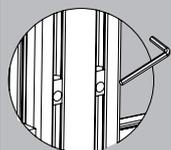
**ASTUCE** / Pour placer un écrou dans une rainure non accessible, insérez l'écrou dans la rainure en l'inclinant puis redressez le à l'aide d'un petit outil comme une clé six pans de petit diamètre par exemple
